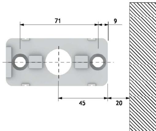
Corretta installazione della base di fissaggio: i segni di riferimento sono allineati
