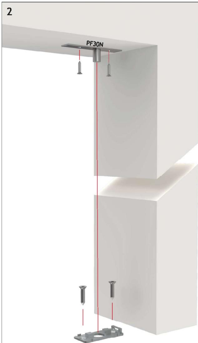
Fissaggio della base e allineamento della rotazione superiore
