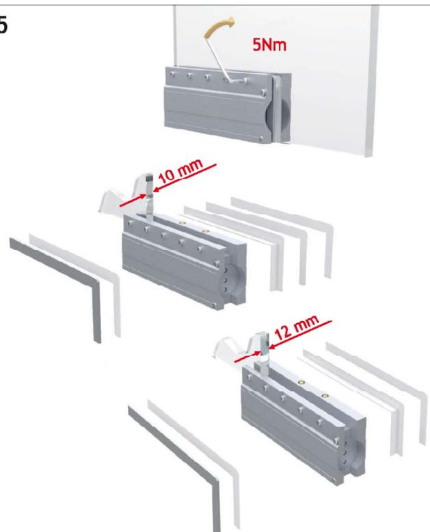
Montaggio della cerniera sulla porta. Il numero di guarnizioni da utilizzare dipende dallo spessore del vetro. Serraggio dei grani di fissaggio a 5Nm mediante la nostra chiave dinamometrica CDK01 (acquistabile a parte)
